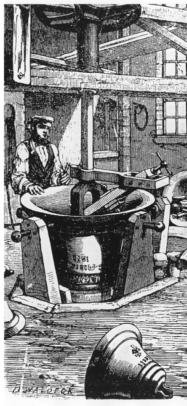
Afb.14: De op stoom aangedreven stembank bij Mears & Stainbank te Londen in het midden van de negentiende eeuw.
